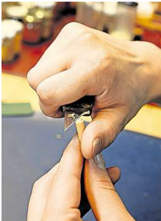
Auch das Verkürzen der «Seele» ist eine Arbeit im Zehntelmillimeterbereich.
