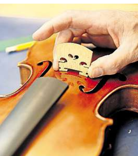
Der Steg wird nicht mit Leim befestigt, sondern wird allein durch die Saiten in der Position gehalten.
