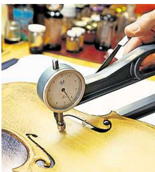
Die Dicke der Decke ist massgebend für den Klang eines Streichinstrumentes.
